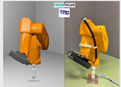
Ein robotergeführter Messkopf prüft kritische Oberflächensegmente von Bauteilen aus 3D-Druck.
